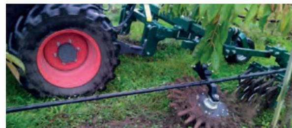
Rollhacke und Fingerhacke am Geräteträgerrahmen
